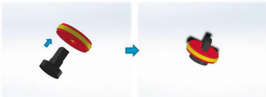
4. Verkleben von holz farbigem Lager mit schwarzer Dreh-Achse / Glue wood colored bearing with black rotary axis
