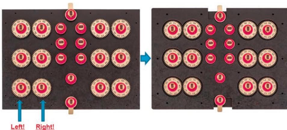
6. Layer 3 auf Layer 2 setzen und Schrauben festziehen. **Vorsicht: Schrauben nur sehr leicht anziehen!!!** / Put layer 3 on layer 2 and tighten screws. **Caution: Tighten screws very easily!!!**
