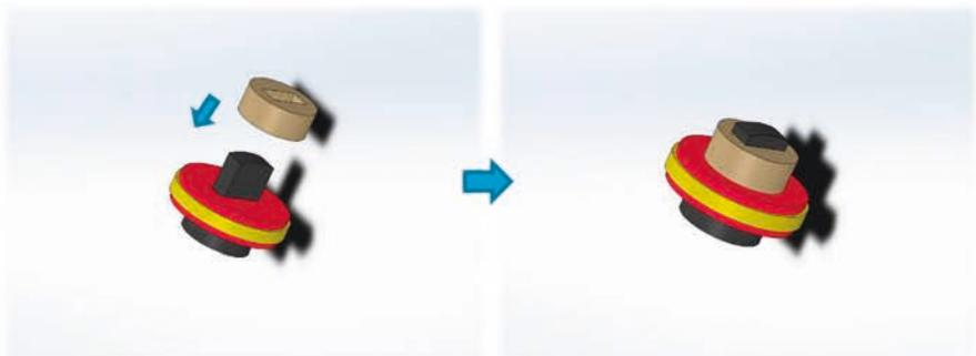
5. Baugruppen in Layer 1 setzen. Danach Layer 2 auf Layer 1 setzen. / Put assemblies in layer 1. Then put layer 2 on layer 1.
