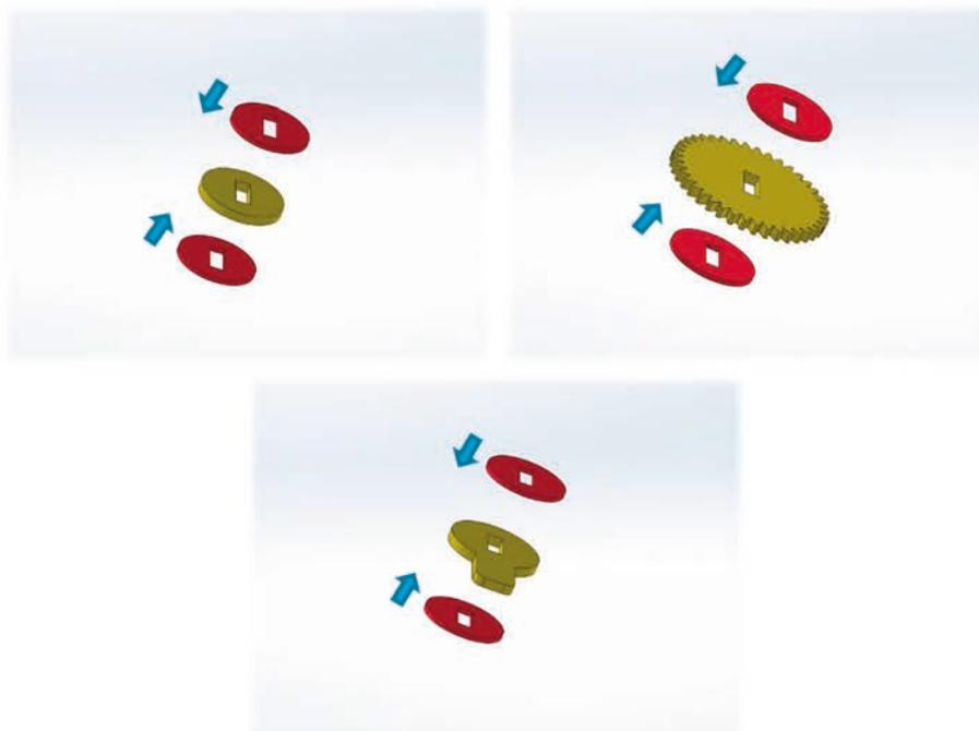
3. Die Drehachsen in die goldenen Bauteile stecken, nicht kleben! / Stick the rotary axes into the golden parts, **do not use glue!**
