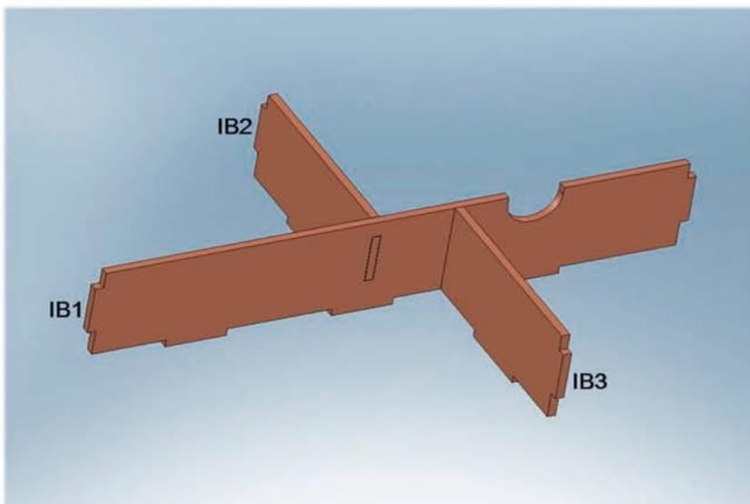
2. Innenwände auf Boden IB4 / Joining inner walls on bottom IB4
