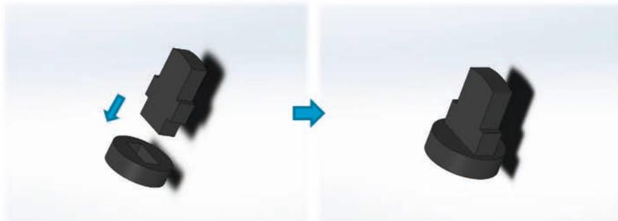
2. Die Filzgleiter (FG) auf beide Seiten der goldenen Teile kleben / Glue the felt gliders (FG) on both sides of the golden parts
