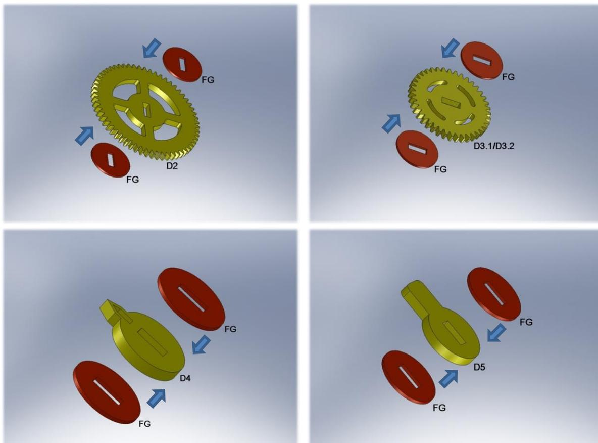
3. Die Teile D2,D3,D4 und D5 auf die Drehachsen stecken, nicht kleben! / Place components D2,D3,D4 and D5 on the rotary axes, **do not use glue!**
