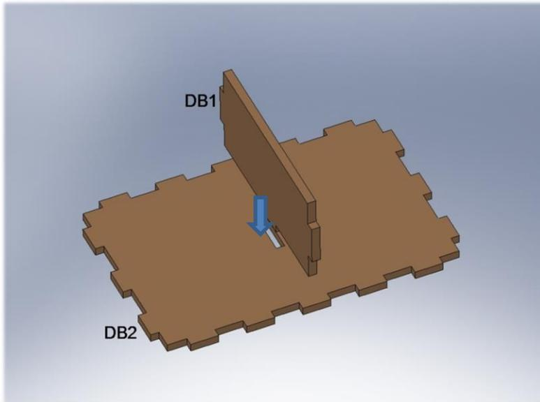
2. Aussenwände anbringen / Joining outer walls
