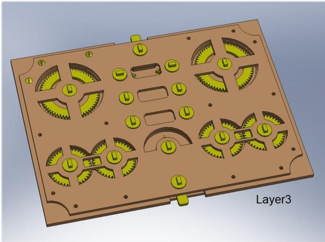
8. Zahnräder D6 und D7 auf Drehachsen setzen und mit wenig Kleber verkleben / Place gears D6 and D7 on the rotary axes. Use only a little glue!
