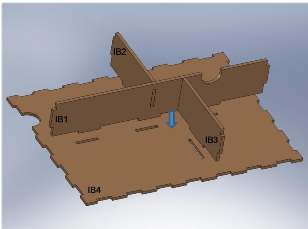
3. Außenwände anbringen / Joining outer walls
