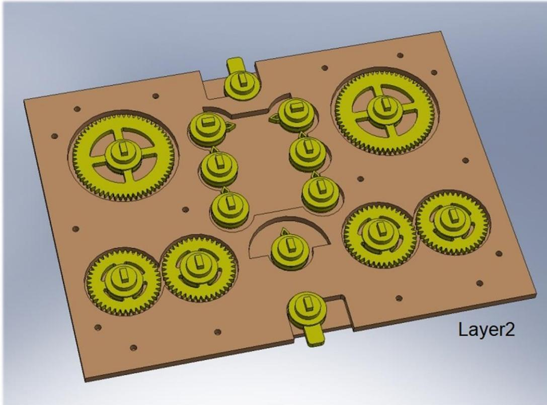
7. Layer 3 auf Layer 2 setzen und Schrauben festziehen. **Vorsicht: Schrauben nur sehr leicht anziehen!!!** / Put layer 3 on layer 2 and tighten screws. **Caution: Tighten screws very easily!!!**
