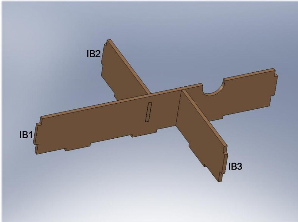
2. Innenwände auf Boden IB4 / Joining inner walls on bottom IB4
