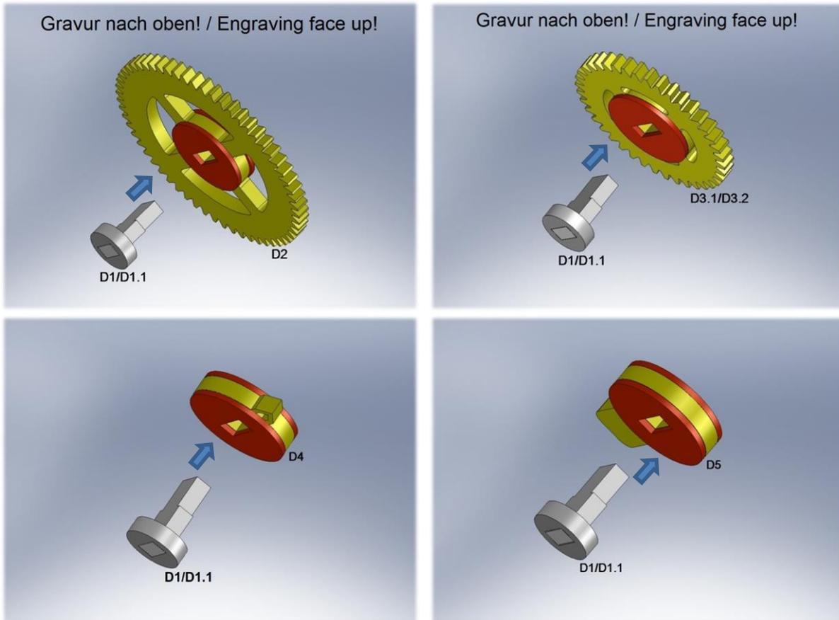
4. Verkleben von Teil D1.2 mit Achse / Glue components D1.2 with axis
