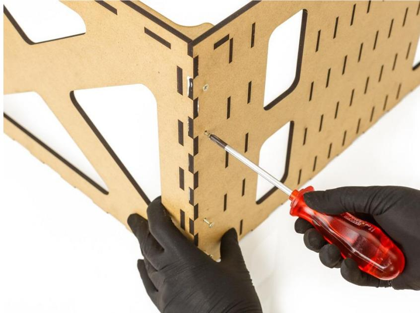
Die Seitenwände auf die Bodenplatte stecken. Überschüssiger Kleber kann abgestreift werden. Nun die Schrauben anziehen, bis der Kopf fast plan zur Oberfläche ist. Vorsicht: Schrauben nicht zu fest anziehen!!! /
