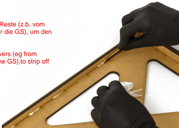
4. Die linke Seitenwand mit der Schrift nach oben vor sich legen. Nun alle Gleitschienen GS in die Seitenwände kleben. / Place the left side wall with the writing face up. Glue all slides GS into the side walls.
